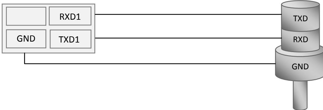
2. Настроить для канала RS232[1] Терминала получение условного уровня топлива или частоты с датчика. Это можно сделать, послав команду RS2321 (раздел [Настройка цифровых входов](#)) или через Конфигуратор на вкладке «Настройки»\«Цифровые входы». По умолчанию все каналы RS232 Терминала настроены на получение условного уровня топлива.
