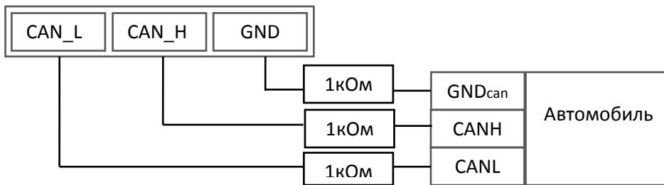
Для включения Терминала в диагностический разъем необходимо использовать первый вариант.
