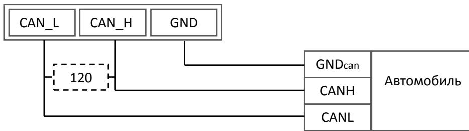
Внимание! Если законцовочный резистор (на чертеже пунктиром) не стоит в шине на ответной стороне, то необходимо его поставить. Его наличие можно определить с помощью мультиметра: при выключенном электронике автомобиля произвести замер сопротивления между CAN\_H и CAN\_L. Если сопротивление порядка 60 Ом, то законцовочный резистор не нужен, если же сопротивление 120 Ом, то необходимо подключить обычный резистор 120 Ом между проводами CAN\_H и CAN\_L.
