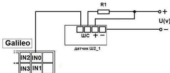
Для подключения 2x датчиков Ш2 к одному из ДАВ используем делитель на двух резисторах.
